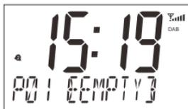
3. Wählen Sie mit den Tasten UP und DOWN die gewünschte Speichernummer von 1 bis 10 aus und drücken Sie zur Bestätigung die SELECT-Taste. Die Anzeige "P # saved" erscheint im Display ("#" steht für die Speichernummer des Senders).
